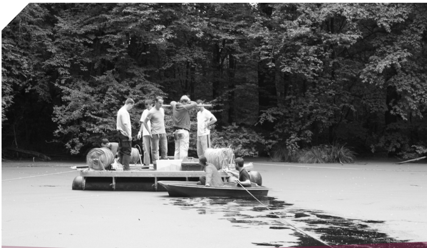
EKIPA NAUKOWCÓW I STUDENTÓW NA PLATFORMIE PONTONOWEJ W TRAKCIE WYKONYWANIA RĘCZNYCH WIERCEŃ W DNIENIE NAJWIĘKSZEGO KRATERU. POBRANE RDZENIE WIERTNICZE SŁUŻĄ DO OKREŚLENIA CZASU UPADKU METEORYTU MORASKO.
