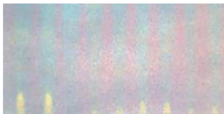
Fot. 3. Chromatografia cienkowarstwowa ekstraktów sukcyńnitów różnego pochodzenia - identyfikacja kwasu bursztynowego (żółte plamki) (wg Matuszewska, 2016a).
