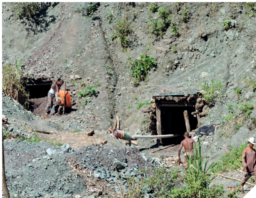
Fig. 8. Szyby eksploatacyjne w kopalni larimaru.
