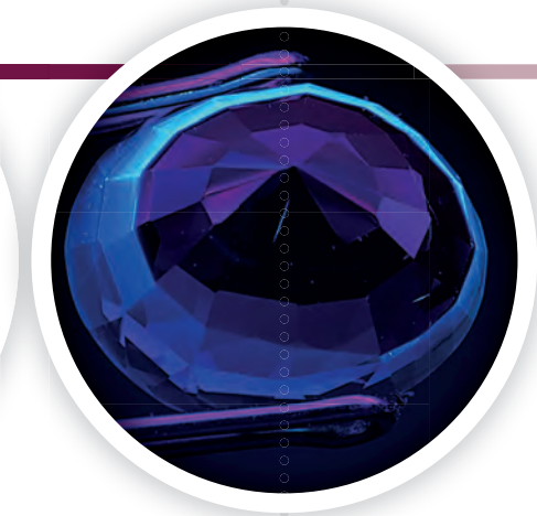
Fig. 4. Silna mlecznoniebieska fluorescencja dla KUV jest cechą diagnostyczną dla szafirów wygrzewanych. Obserwowany jasny pierścień odpowiada bezbarwnej strefie w szafirze.
