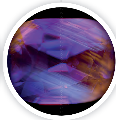
Fig. 9. Różowopomarańczowa fluorescencja dla DUV niebieskich szafirów naturalnych z Madagaskaru. Obserwowane obszary fluorescencji odpowiadają równoległym, bezbarwnym strefom wzrostu.
