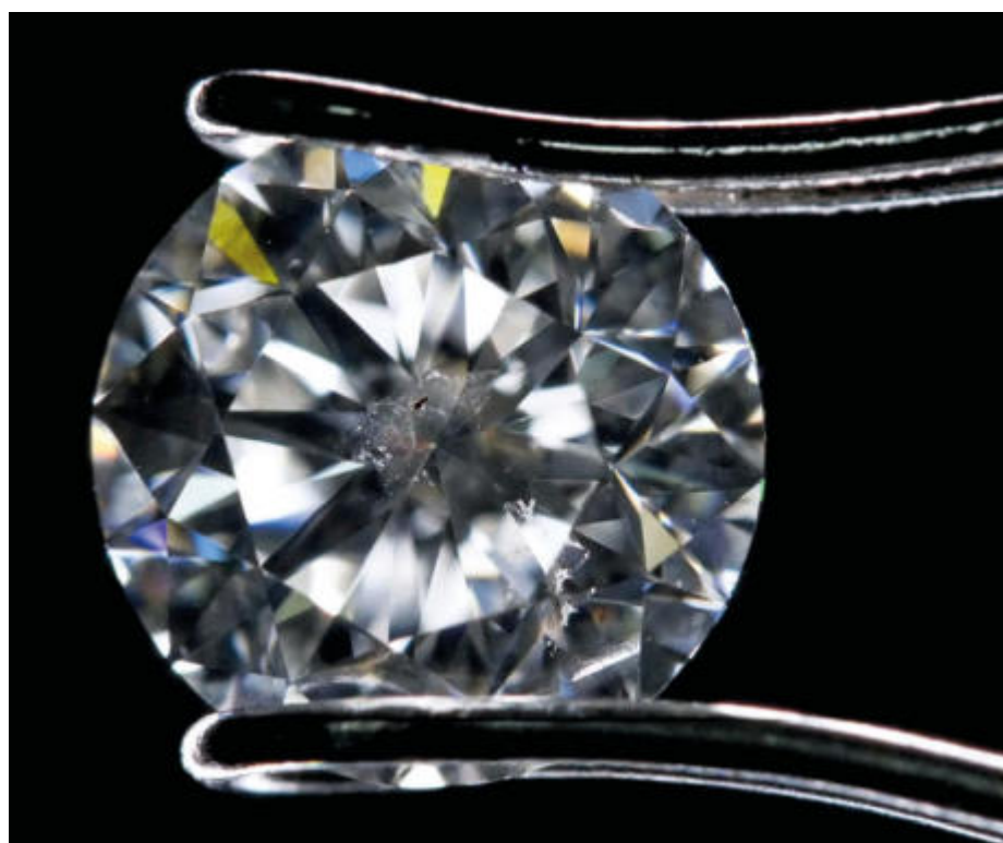
Fig. 8. Łatwo rozpoznawalne inkluzje pod taflą diamentu SI2.
