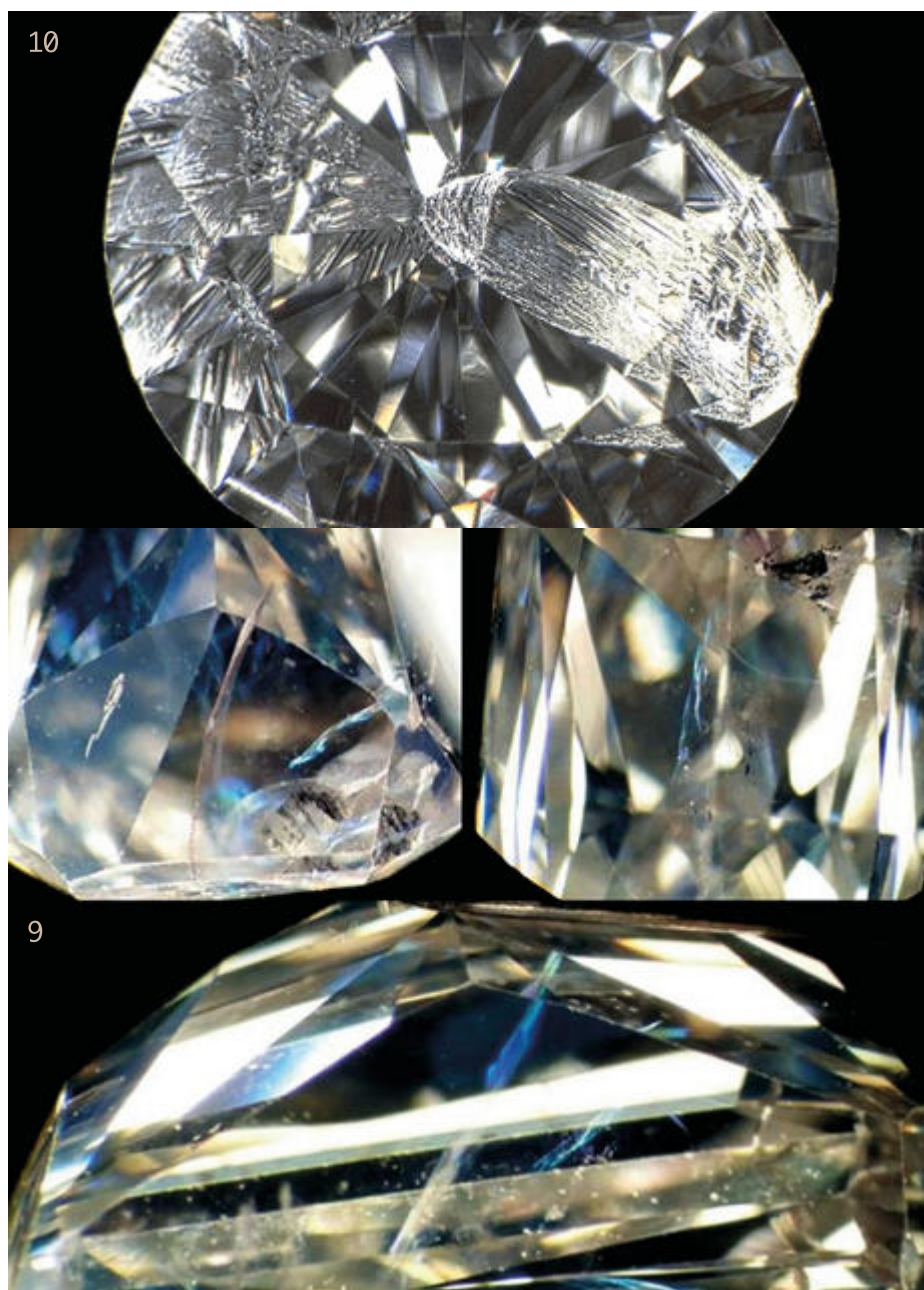
Fig. 9. „Niebezpieczne” pęknięcia i szczeliny lupliwości w diamencie. Fig. 10. Znaczący ubytek w diamencie i jego zwierciadlane odbicie.
