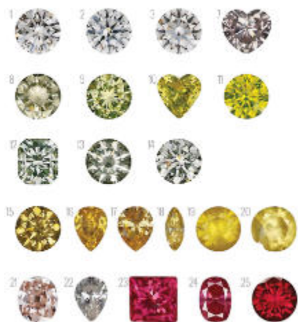
Fig. 6. Badane diamenty z centrami fluorescencyjnymi: 1-3 centra N3, 7 centra N3 i H3, 8-11 centra H3, 12-14 centra H4, 15-20 pasmo 480 nm, 21-25 centra N-V.
