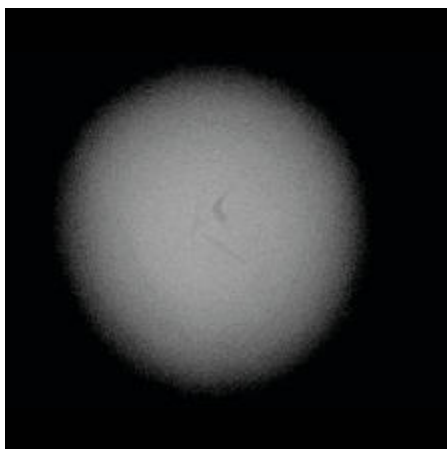
Mikroradiogram hodowanej perły bezjądrowej. We wnętrzu perły obserwujemy niewielką pustą przestrzeń, której nie wypełniła masa perłowa. Dużo wyraźniej widać ją na zbliżeniu.
