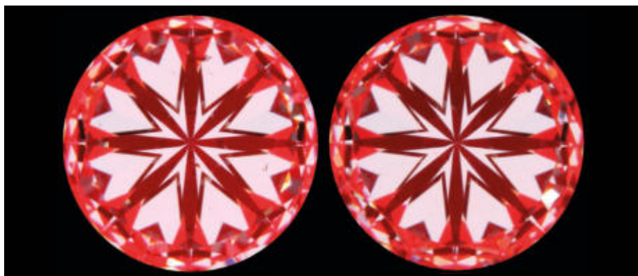
Prawidłowy obraz diamentu H&A. Bliski prawidłowemu obraz diamentu H&A.
