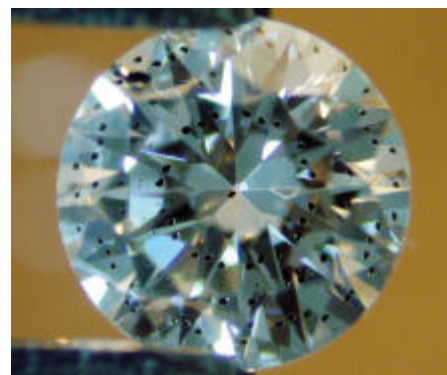
Fig. 7. Czarne wrostki grafitu zwane pieprzem.
