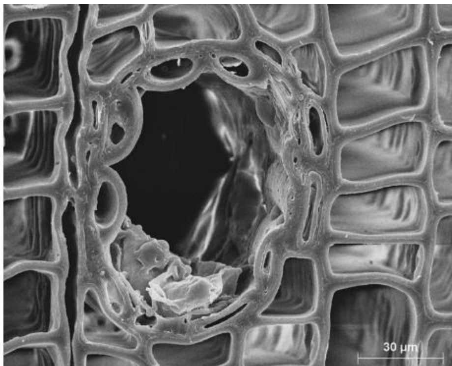
Ryc. 15. Przekrój osiowy kanału żywicznego świerka pospolitego.
